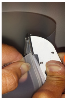
5. Insérer la glissière gauche sur la partie oblique au fond de la gorge gauche de l'outil, comme pour une fermeture éclair classique.
