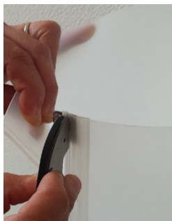
4. Insérer la glissière droite au fond de la gorge droite de l'outil.
