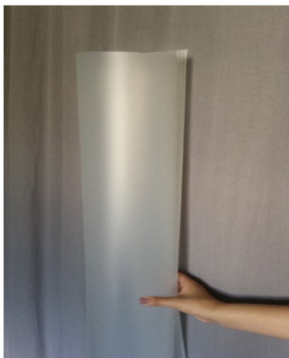
1. Rouler la feuille PMMA en cylindre
